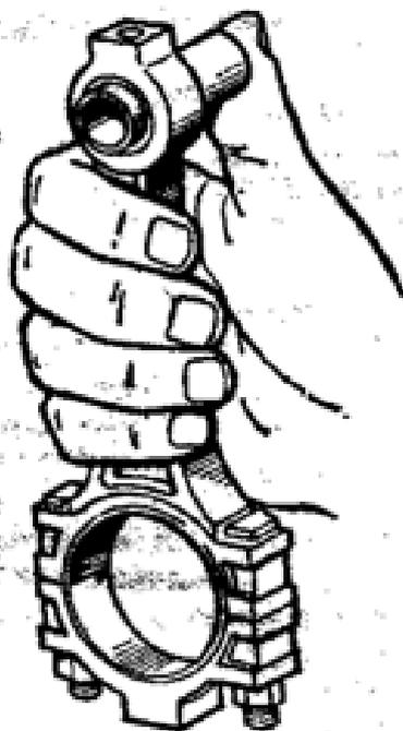
Рис. 40. Проверка подбора поршневого пальца к втулке верхней головки шатуна
