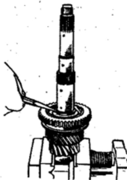
Рис. 146. Снятие стопорного кольца ступицы ведомой шестерни заднего хода
