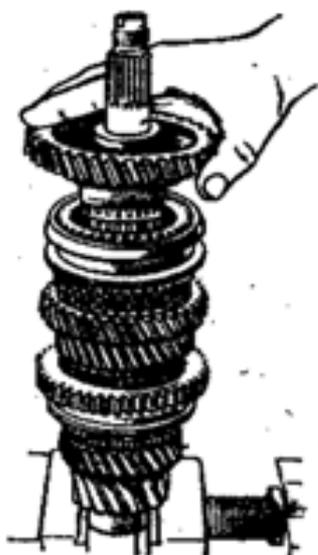
Рис. 142. Снятие ведомой шестерни первой передачи
